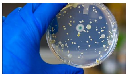
Die Art des Schimmelpilzes und seine Konzentration sind exakt messbar. Mit dem sogenannten Sammelgerät wird dafür ein bestimmtes Luftvolumen durch einen Membranfilter gesaugt. Danach wird der Pilz entweder auf einen Nährboden gelegt, geprüft und ausgezählt, oder in eine Lösung gebracht und nach Anlegen einer Verdünnungsreihe auf vorbereitete Nährböden verteilt. So erfolgt die Überprüfung und Auszählung. Die Auswertung dieser Proben beansprucht circa 8 Tage.
